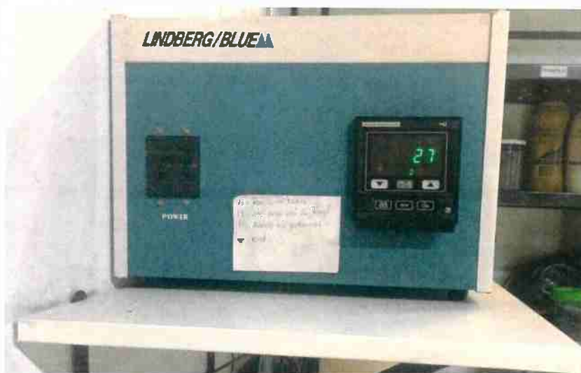
Figura 15 - Central eletrônica de ajuste dos parâmetros da carbonização
