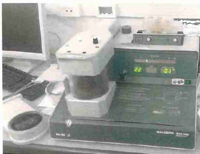
Figura 25 - Equipamento utilizado para metalização
